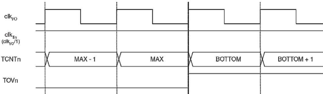
**Рисунок 33** - Временные Диаграммы Таймера/Счетчика (Предделитель не используется)
