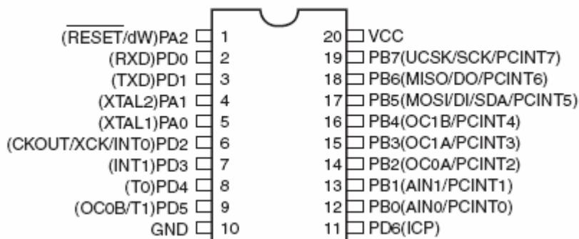
Рисунок 1 – Цоколевка ATtiny2313 в двух типах корпуса
