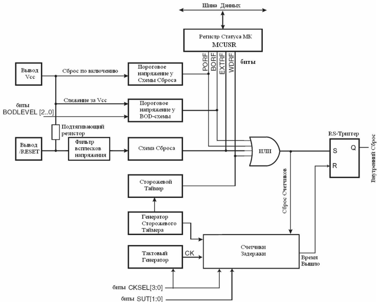
Рисунок 14 Логическая Схема Сброса МК
