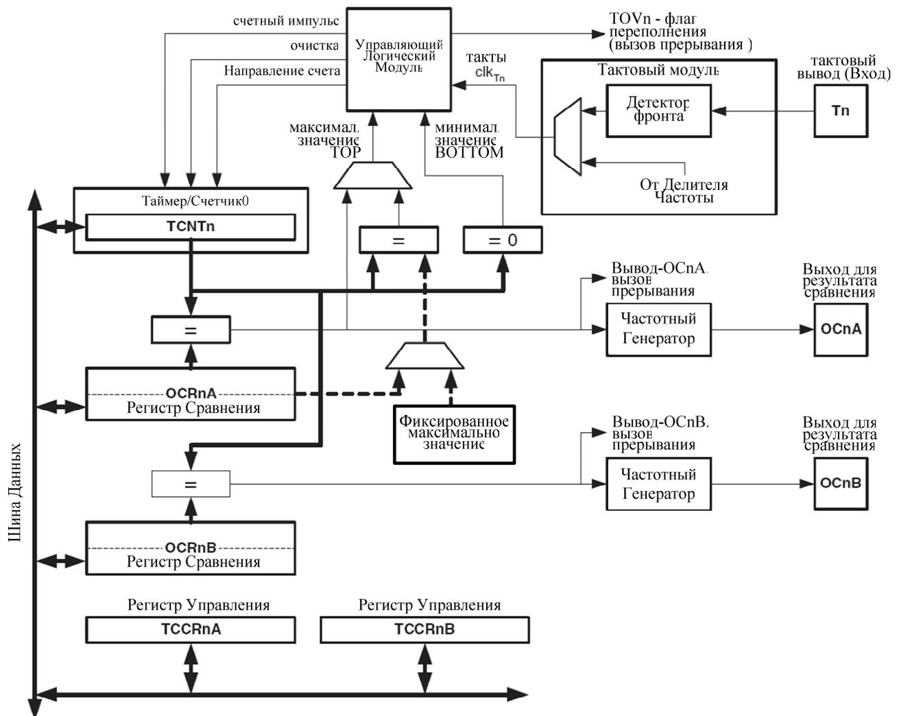
Рисунок 26 - Упрощенная блок-диаграмма 8-битного Таймера/Счетчика 0
