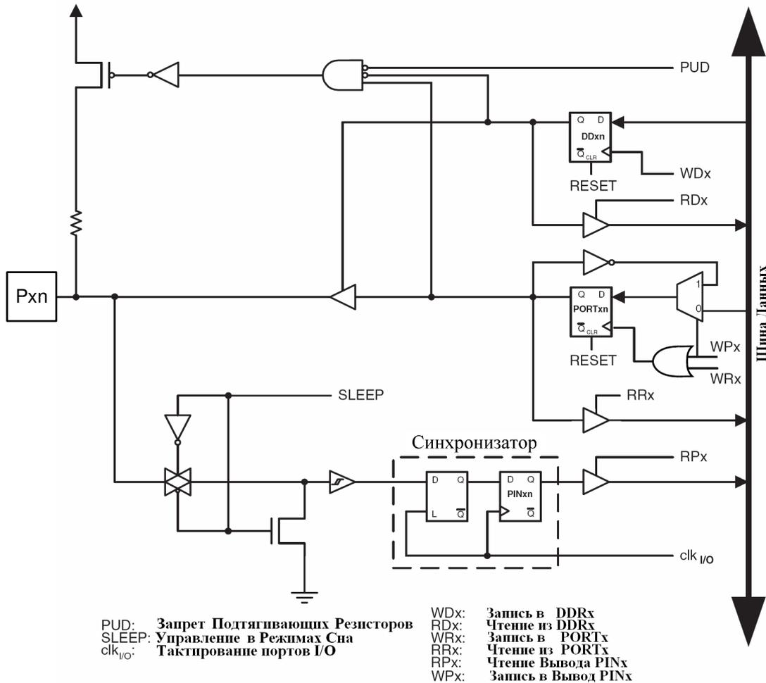
Рисунок 22 – Вывод для Общего Цифрового Ввода/Вывода
