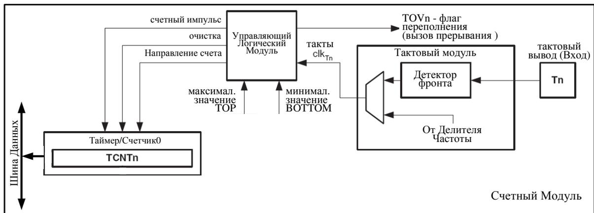
Рисунок 27 - Блок-диаграмма Счетного Модуля
