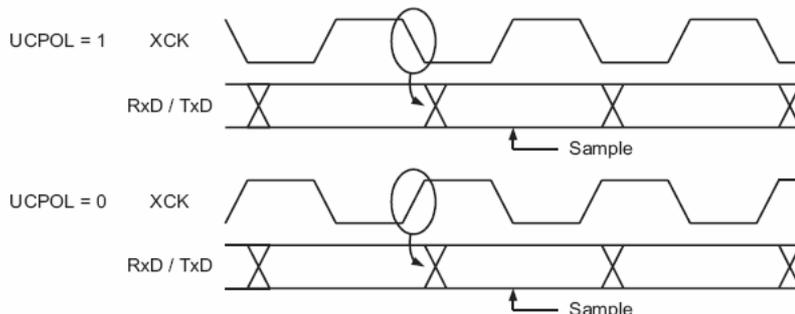
Рисунок 54 – Временные диаграммы для Синхронного режима
