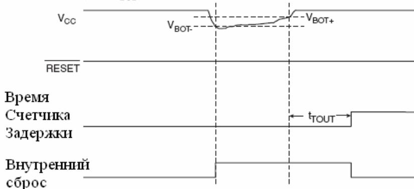
Рисунок 18 – Сброс BOD-схемой во время работы МК
