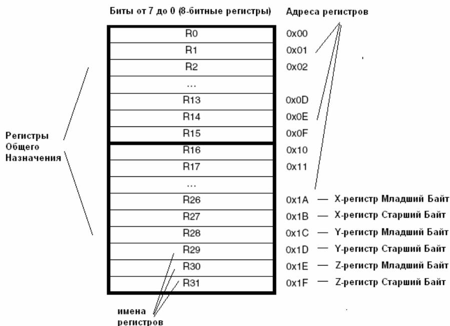
Рисунок 4 - Структура 32 Регистров Общего Назначения
