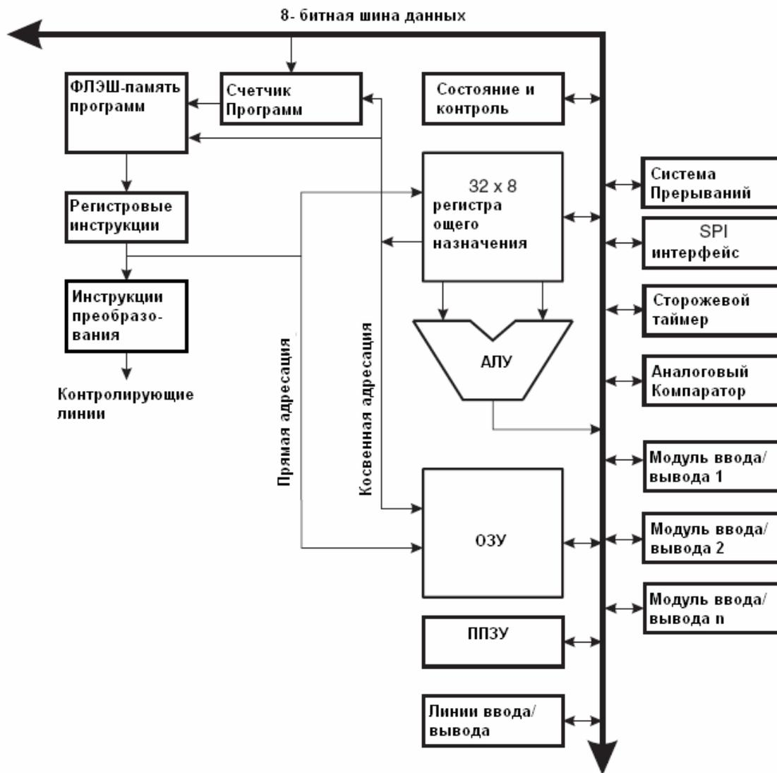
Рисунок 3 – Блок-Диаграмма AVR-архитектуры
