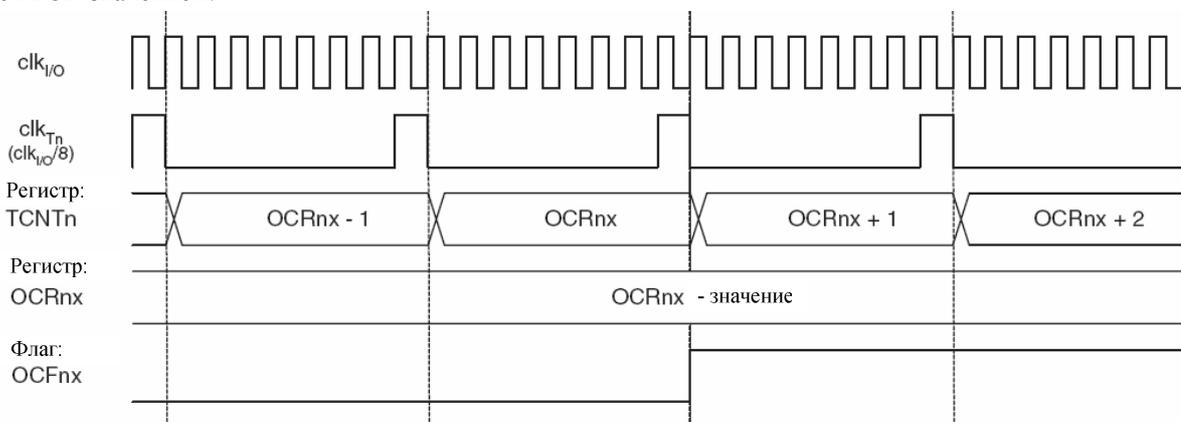
**Рисунок 35** - Временные Диаграммы Таймера/Счетчика с Установкой Флагов OCF0x с использованием Предделителя ( $f_{clk/I/O}/8$ )
