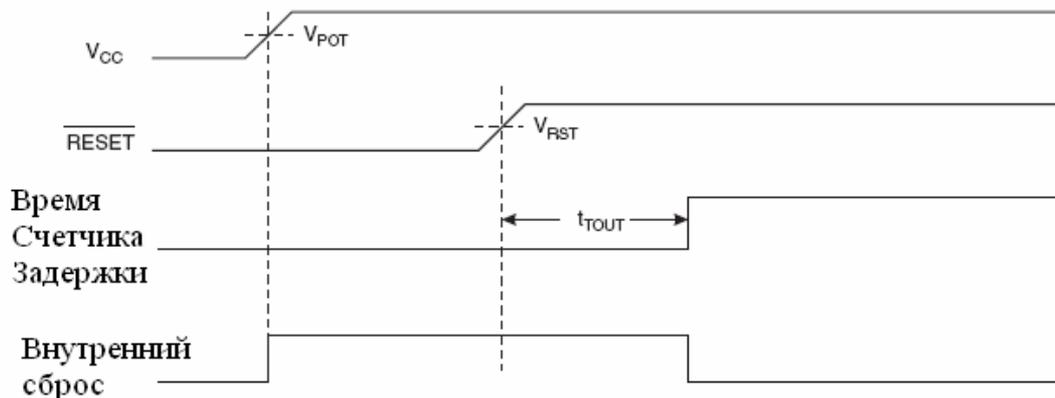
Рисунок 16 – Временная диаграмма Периода Включения МК
