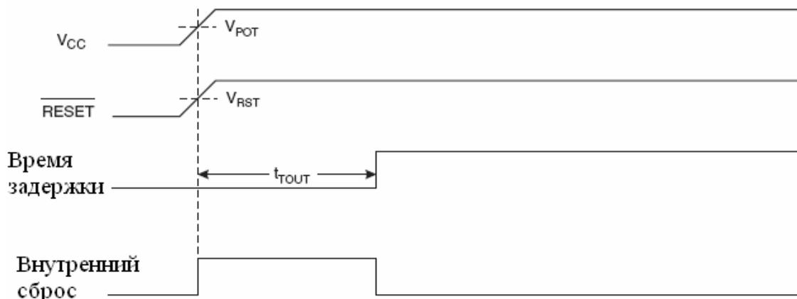
Рисунок 15 – Загрузка МК, RESET привязан к  $V_{CC}$
