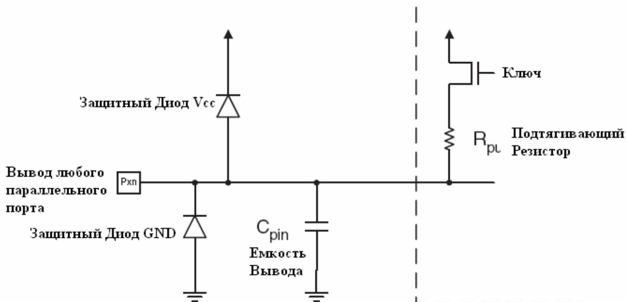
Рисунок 21 – Схема I/O-портов
