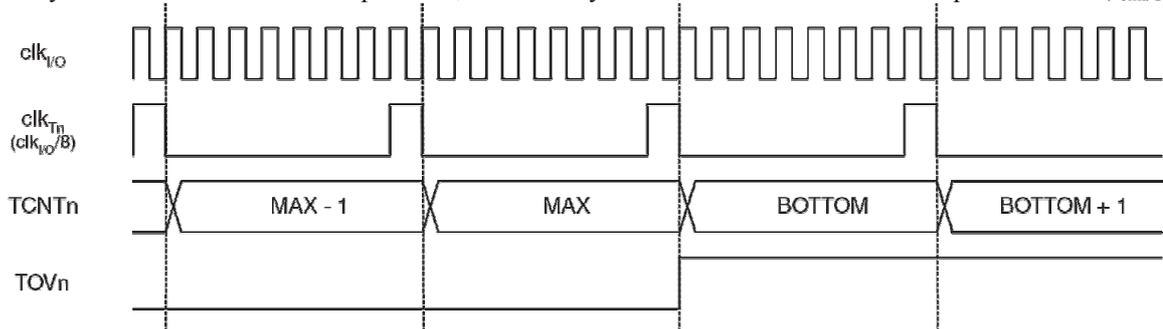
**Рисунок 34** Временные Диаграммы Таймера/Счетчика при использовании Предделителя ( $f_{clk/I/O}/8$ )
